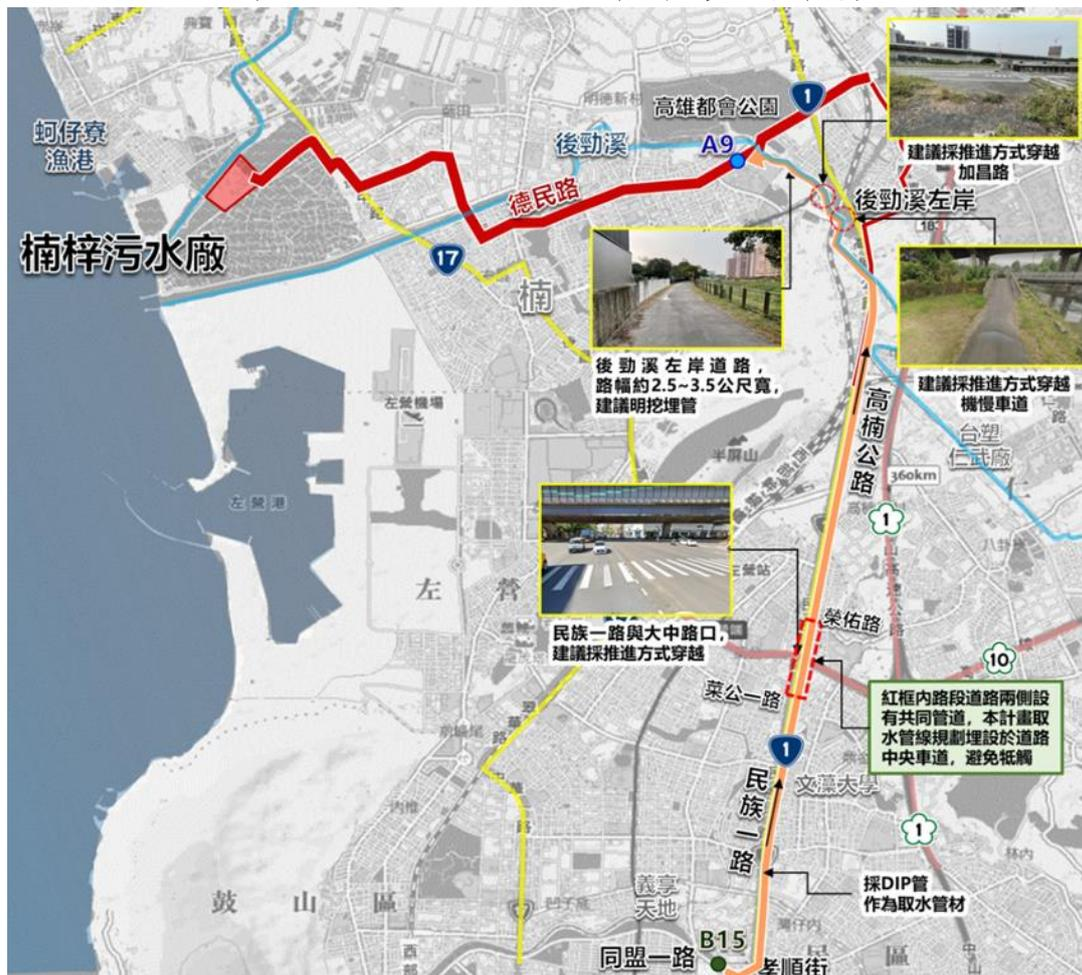
圖 1.3-18 取水路線示意圖（路線一）
