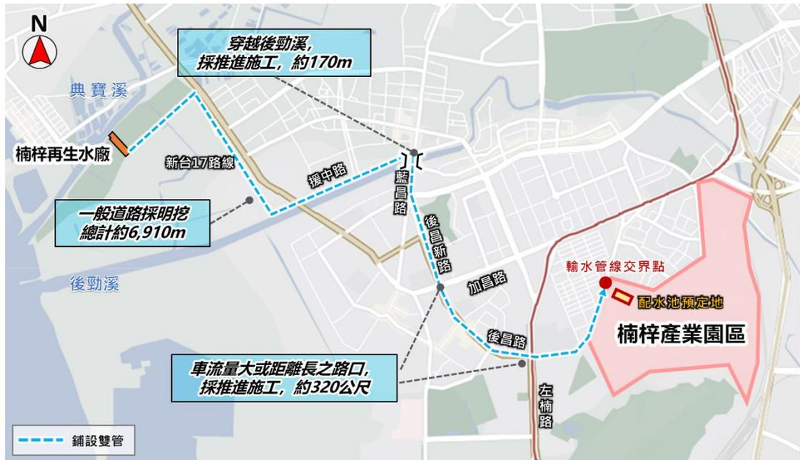
圖 1.3-30 輸水路線施作工法示意圖
