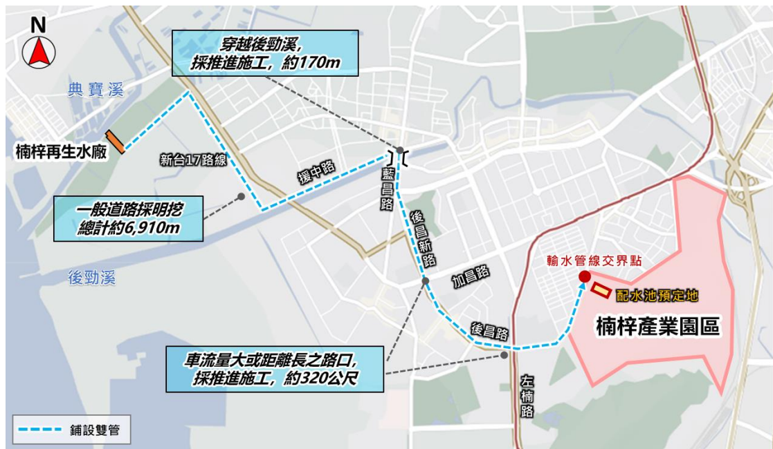
圖 1.3-30 輸水路線施作工法示意圖
