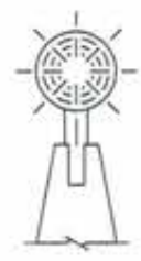
錐頂反光導標 附註: 使用於夜間工程加裝錐頂反光導標, 燈具為橙色具反光效能
