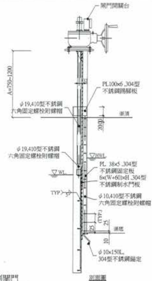
3 水位控制閘門
