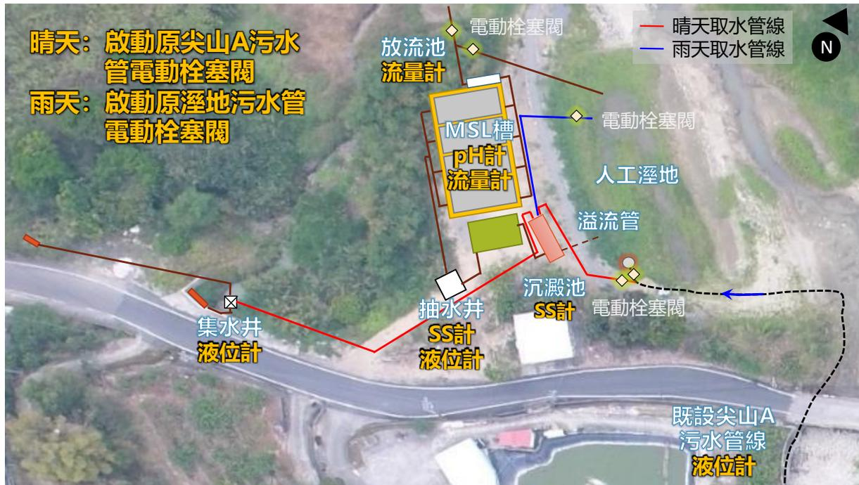
圖 2.5-1 平面配置及儀控位置圖
