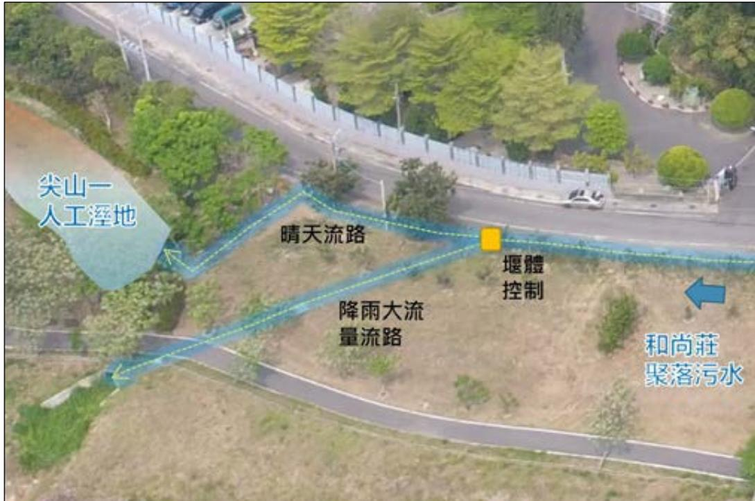
圖 6.6-2 和尚莊聚落污水截流進入人工溼地流向示意圖
