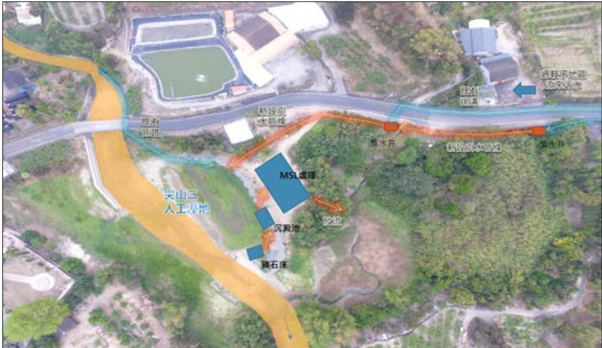
圖 6.5-5 過鞍子與尖山 A 地區污水處理構想示意圖
