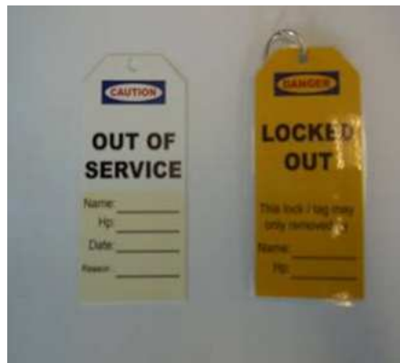
照片4 嚴格遵守帶電操作的安全規範衣規定掛牌上鎖
