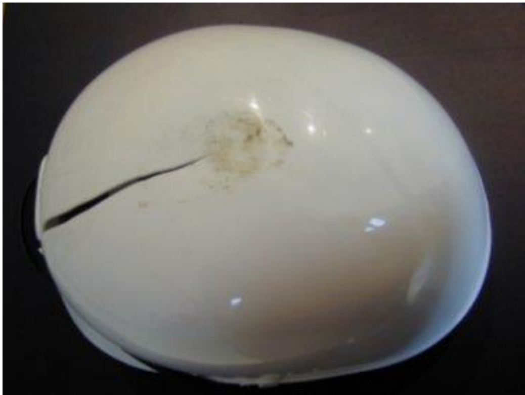
圖 1 膠盔經衝擊試驗後損壞情形
