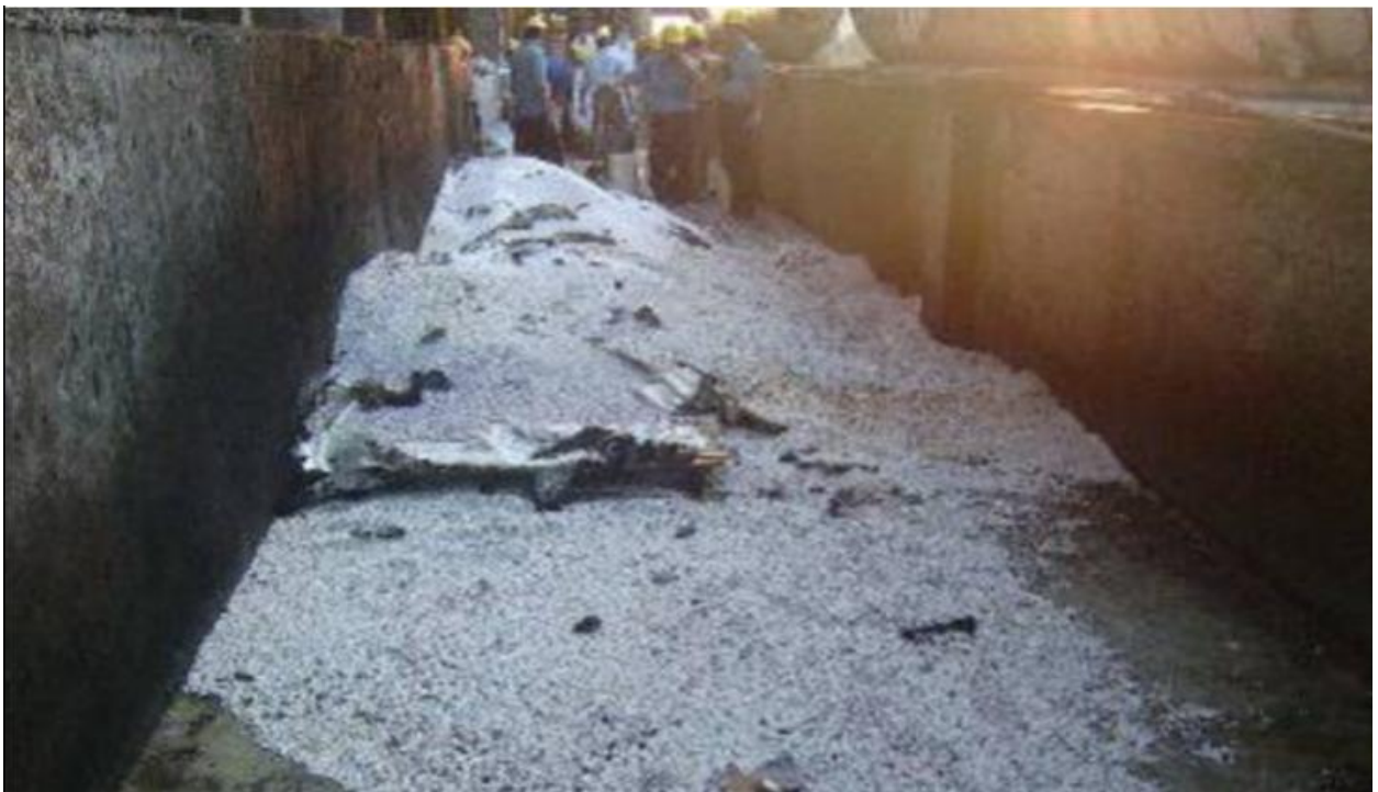
含有有機物質廢棄多孔性氧化鋁球燃燒後情況
