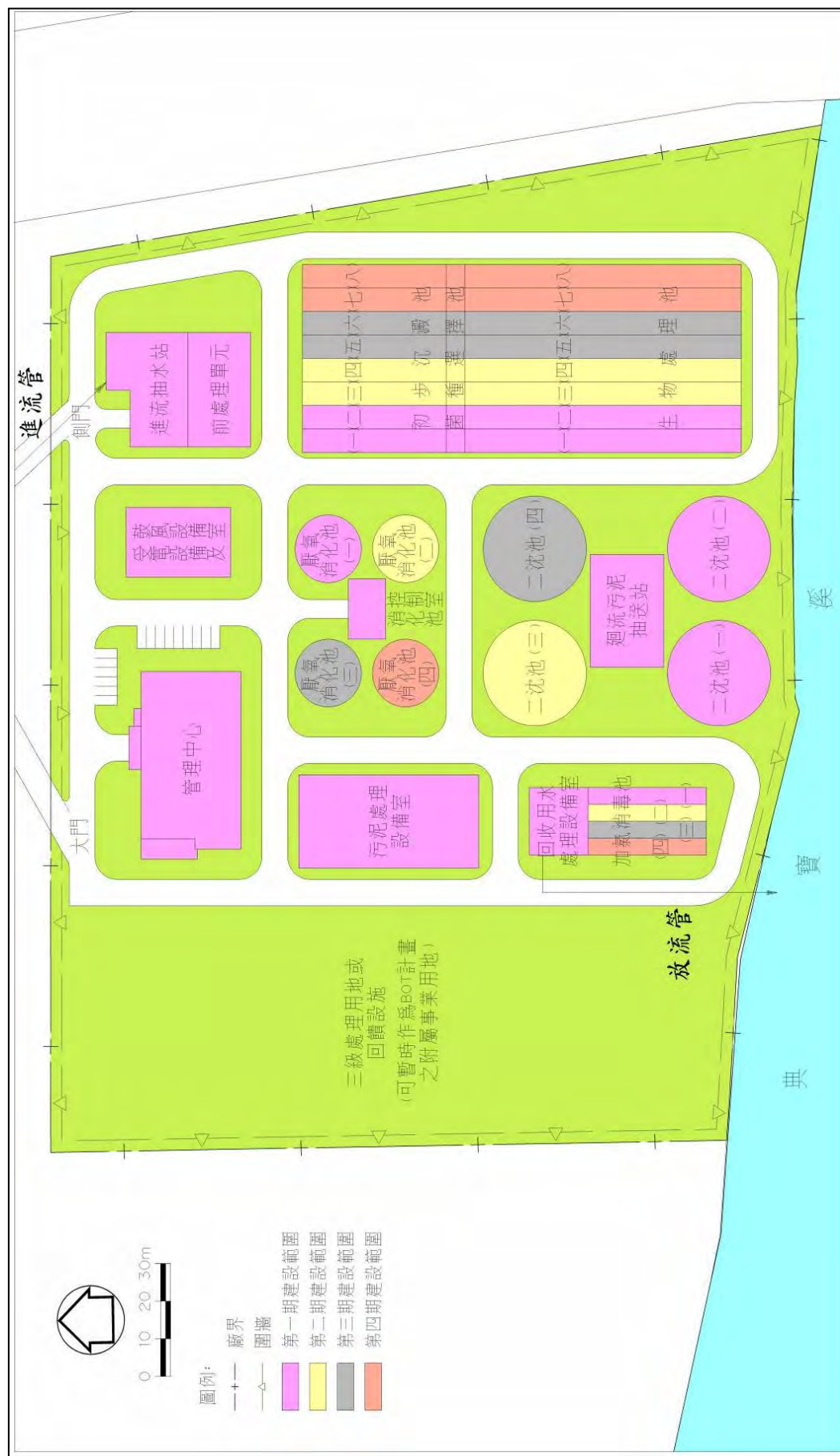
圖 1.1-5 岡山橋頭污水處理廠平面配置圖
