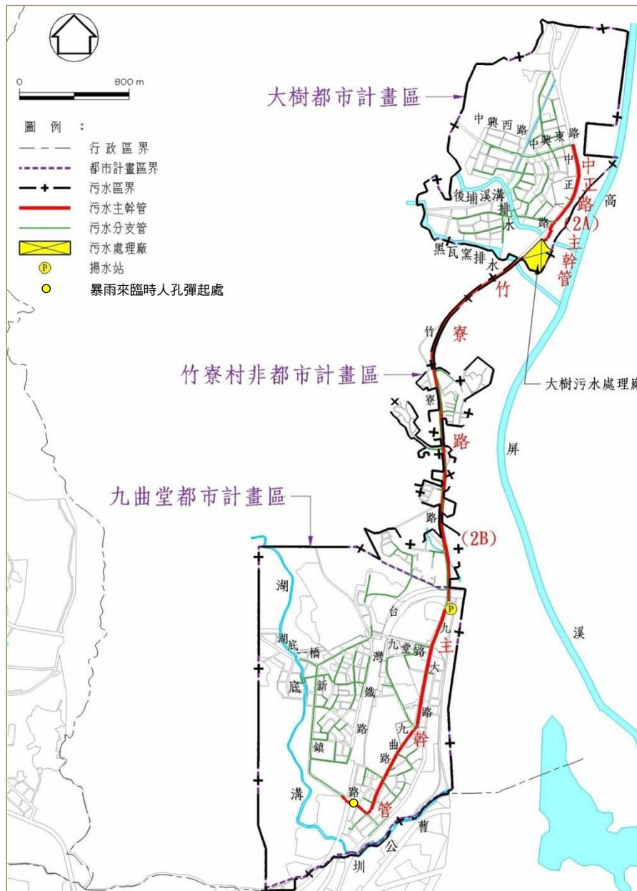
圖 6.9-3 暴雨來臨時人孔彈起位置示意圖
