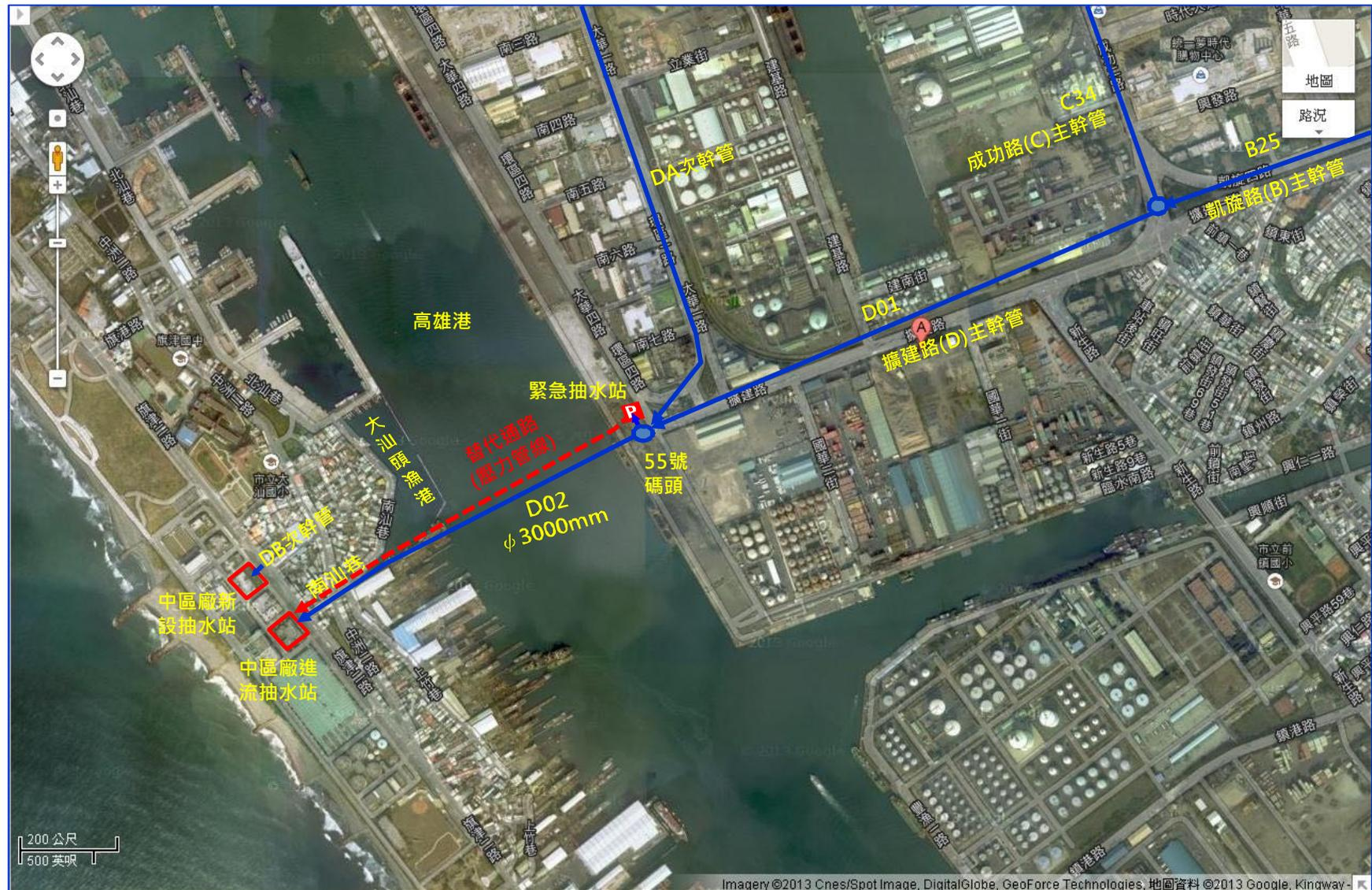
圖 6.1-6 高雄污水區污水下水道系統擴建路主幹管及(過港段)替代管線位置示意圖
