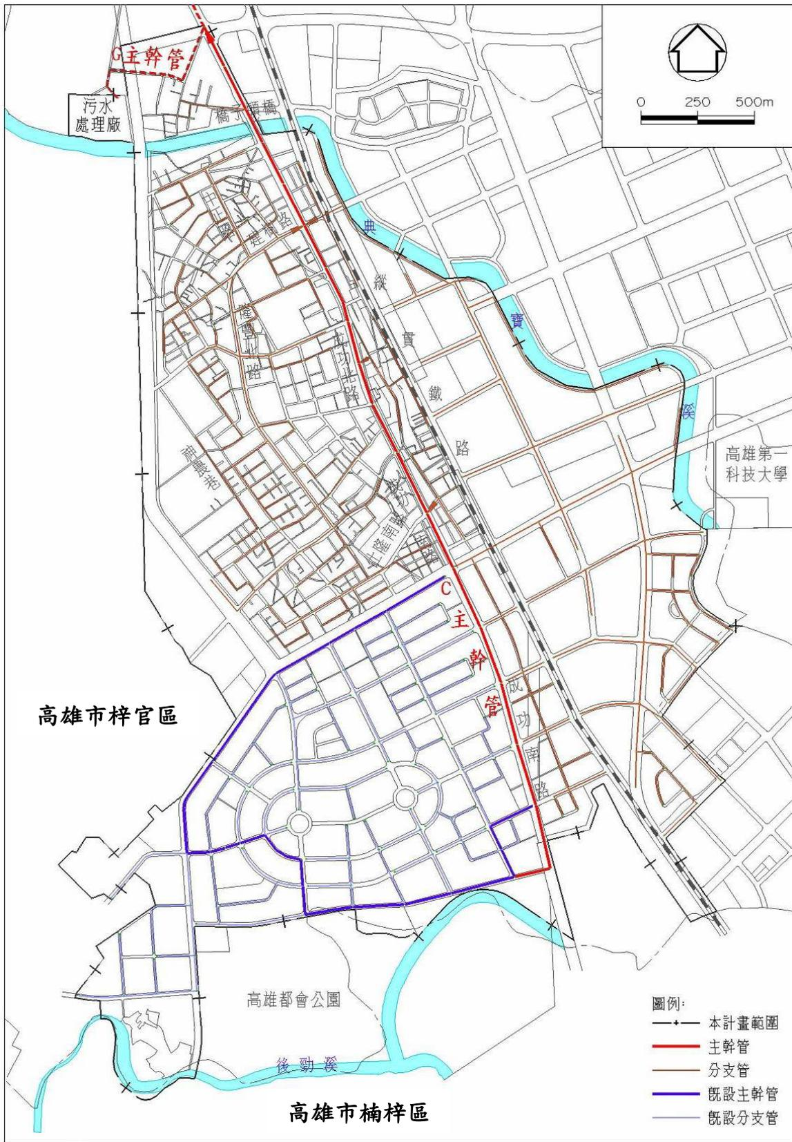
圖 3 橋頭地區污水下水道系統管網配置圖
