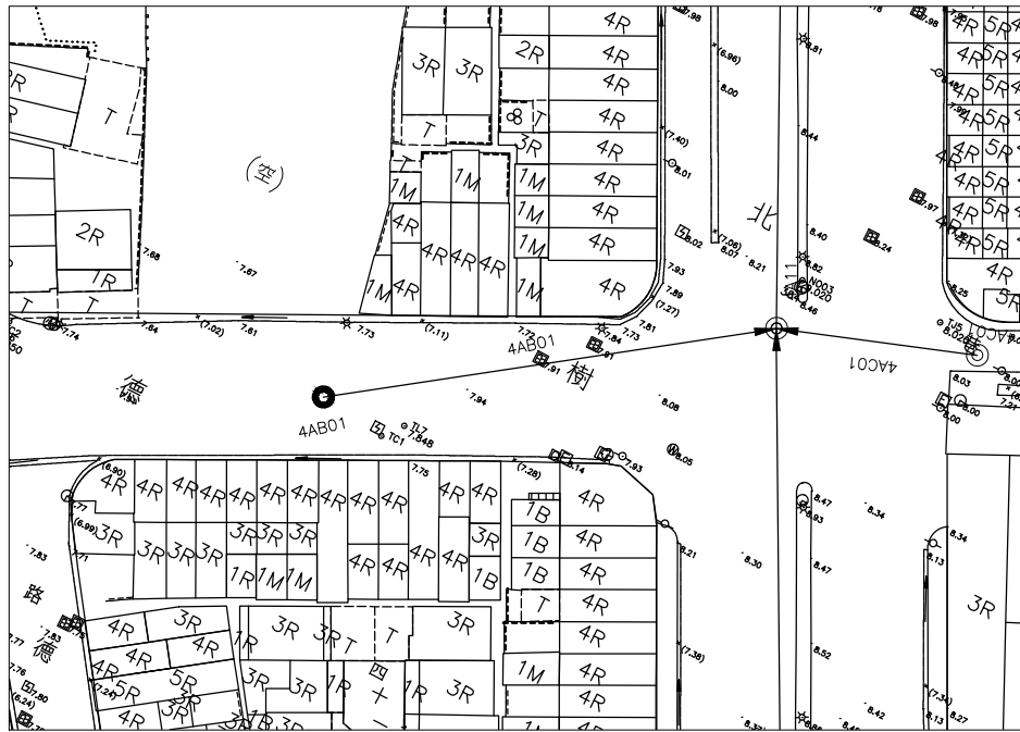
4AB01~4A11污水管線平面圖
