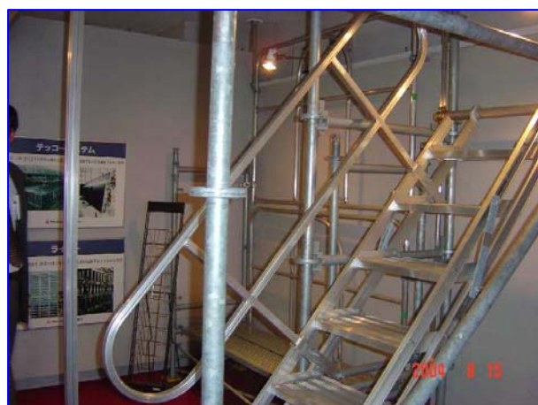
照片 2：上下設備樓梯應有適當護欄（得採足以防護工作者墜落之上端交叉拉桿扣釘固定上拉桿等設備代替）。
